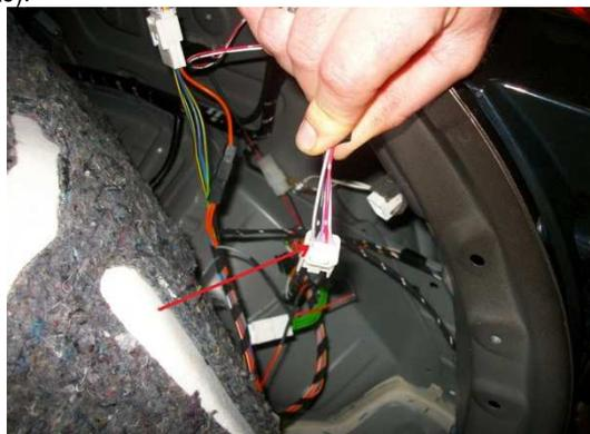
El cajetín electrónico de las luces de remolque requiere las alimentaciones de los antinieblas para poder apagar las luces en el vehículo y alimentar las luces del remolque cuando la toma está conectada. Esta toma de información se realiza mediante 2 derivaciones en el haz de bola de enganche (cables indicados con la flecha en la foto):
