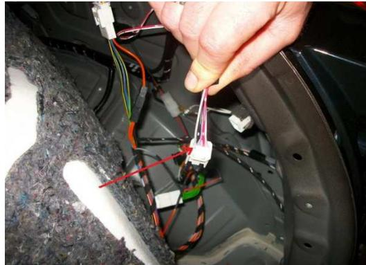
Das elektronische Steuergerät für die Beleuchtung (Scheinwerfer) des Anhängers braucht die Versorgungen der Nebelscheinwerfer, um das Abschalten der Scheinwerfer durchführen und um die Beleuchtung des Anhängers versorgen zu können, wenn der Stecker angeschlossen ist.
